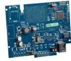
Comunicador de alarma vía Internet (con conexión en serie opcional para integración) (TL280(R)E)
