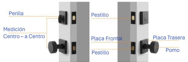
4 Confirme si la puerta actual tiene doble acción. Cerrojo en la parte superior y manija en la parte inferior o que solo tenga una cerradura.
